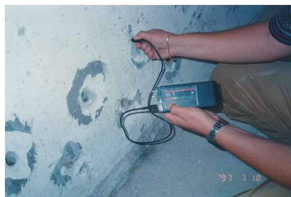
A sx posa del ferro per il getto in CLS - A dx verifica con strumento della percentuale di umidità nei locali
